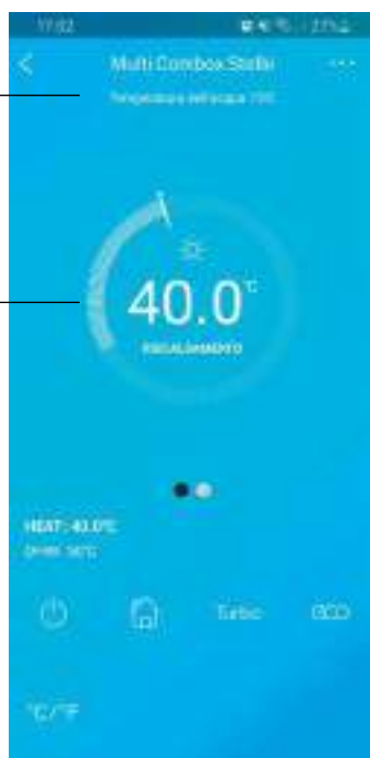
Set point riscaldamento Temperatura acqua mandata
